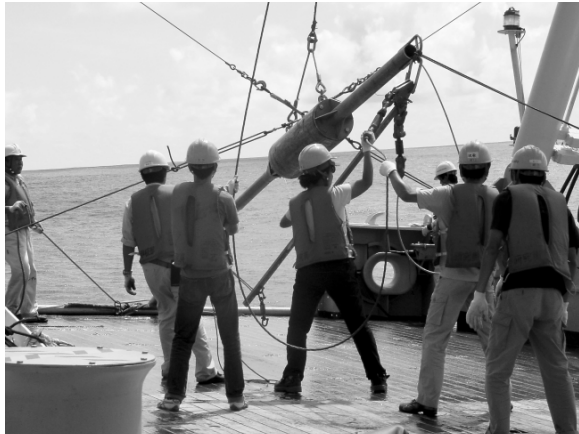
写真4：海底に打ちこんだ海底堆積物のピストンコアを回収している作業風景です。見てのとおり、コアはかなり長いです。この後は、まずコアの深度毎の色を測定し、その後コア中の粒子組成やアルケノン等の有機物の測定を行い、古環境に関する情報を取得していきます。
