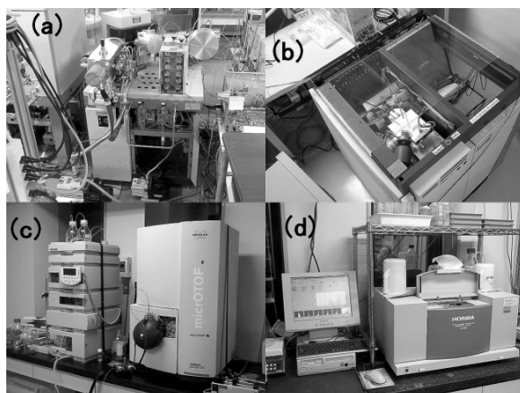
写真2：本グループで使用している測定機器の一例です。(a)：同位体質量分析計 (MAT 253; Thermo Fisher Scientific), (b)：同位体質量分析計 (DeltaV; Thermo Fisher Scientific), (c)：液体クロマトグラフ質量分析計 (microOTOF-HS; Bruker Daltonics), (d)：レーザー回折・散乱型粒度分析装置 (LA-920; HORIBA)
