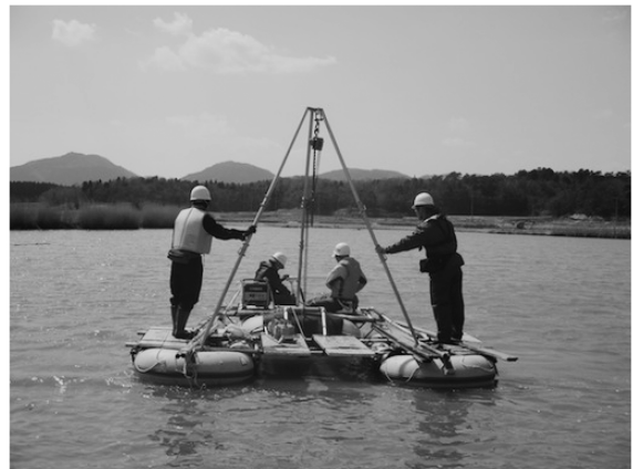
写真3 湖上での掘削の様子。ゴムボートを浮かべて湖底堆積物を採取する。
