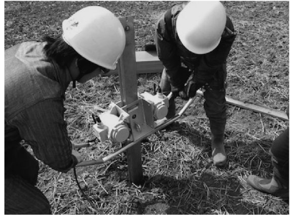
写真2 ジオスライサーと呼ばれる掘削器具を用いた陸上での掘削の様子。
